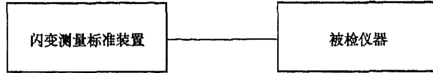
图 9 标准源法闪变值检定示意图
