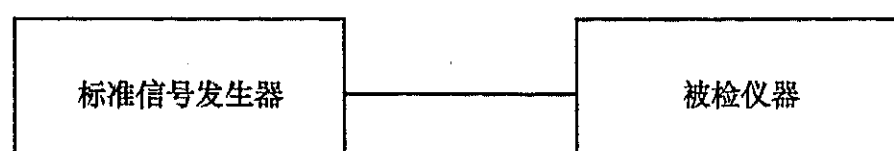
图 3 标准源法频率测量误差检定示意图
